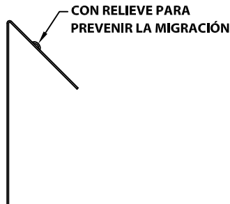
PRESILLA DE ANCLAJE PARA INGLETES DE (2) LARGAS PIEZAS DE 14" DE LARGO POR INGLETE
